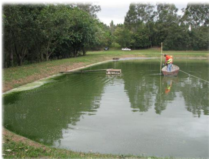
Imagem 10.6: Vista geral do levantamento batimétrico realizado na lagoa facultativa.
